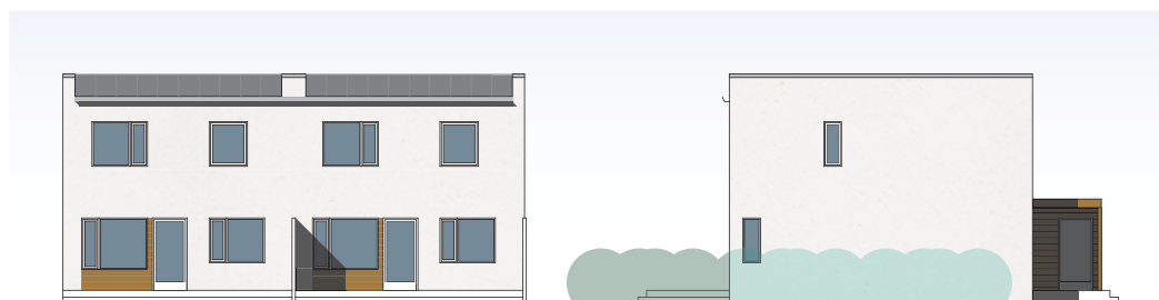
Putsfasad med träpanelinslag
