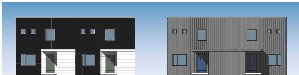
Putsfasad med träpanelinslag Standard fasaduttryck på entrésida
